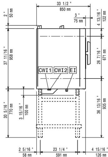
CWI1 = Kaltwasserzulauf                      EI = Elektroanschluss
